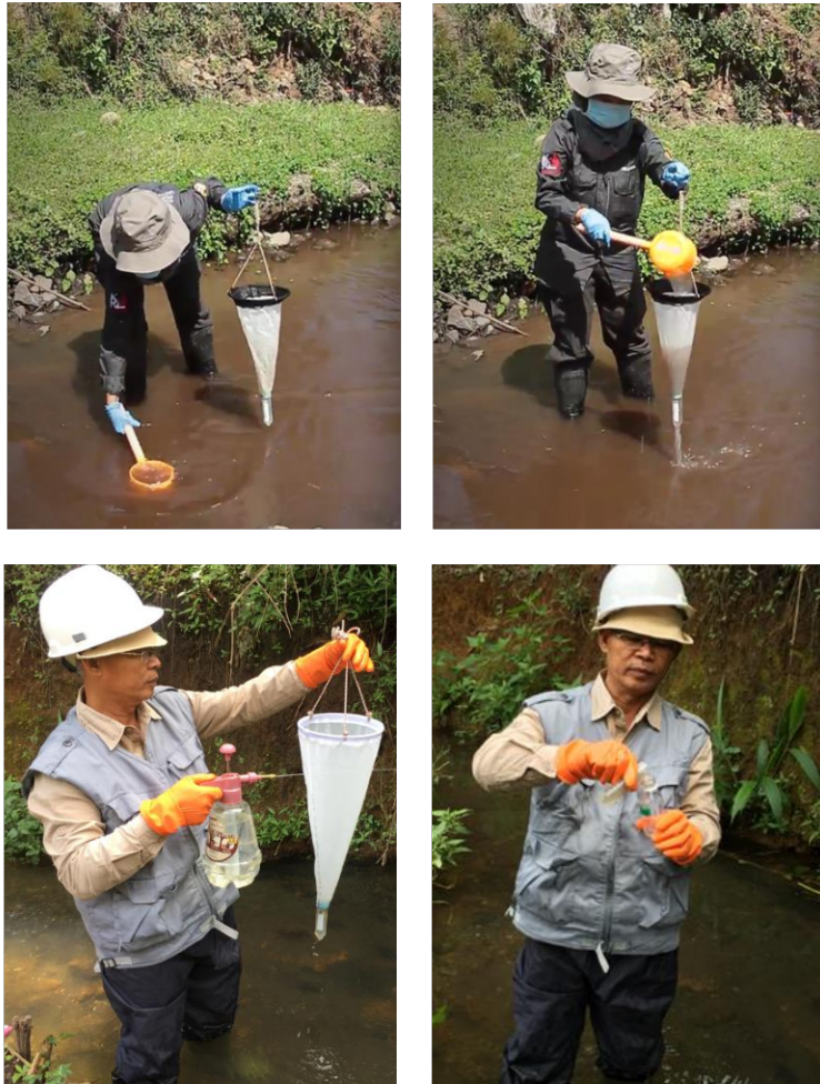
Gambar 2.20 Kegiatan pengambilan, pembilasan, dan pemindahan sampel plankton di perairan mengalir yang dangkal
